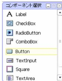
コンポーネント選択ウィンドウのコンポーネントにカーソルを合わせると、選択されているコンポーネントがハイライト表示されます。
